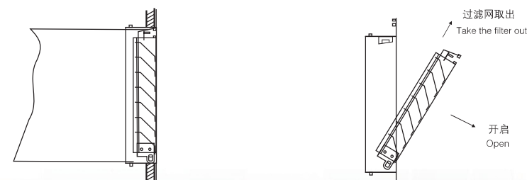
YRK安装方式之一 ONE OF THE WAY TO INSTALL YRK YRK+YR2尼龙过滤网 NYLON FILTER
