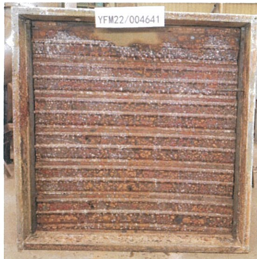
照片 1 耐火性能试验前试件情况
