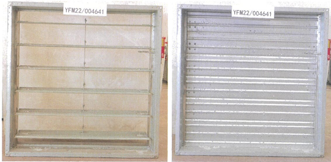
照片 1 耐火性能试验前试件情况
