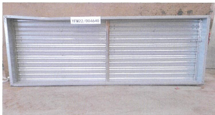
照片 1 耐火性能试验前试件情况
