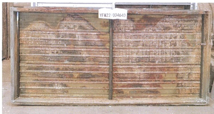
照片 2 耐火性能试验结束时试件情况
