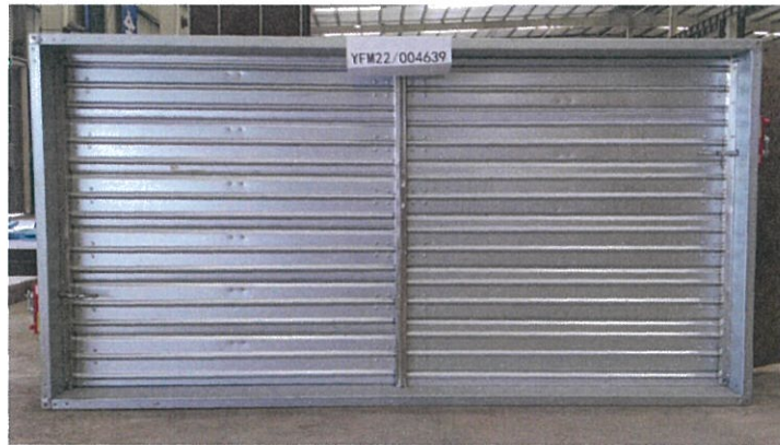
照片 1 耐火性能试验前试件情况
