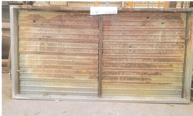
照片 2 耐火性能试验结束时试件情况
