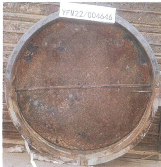
照片 2 耐火性能试验结束时试件情况
