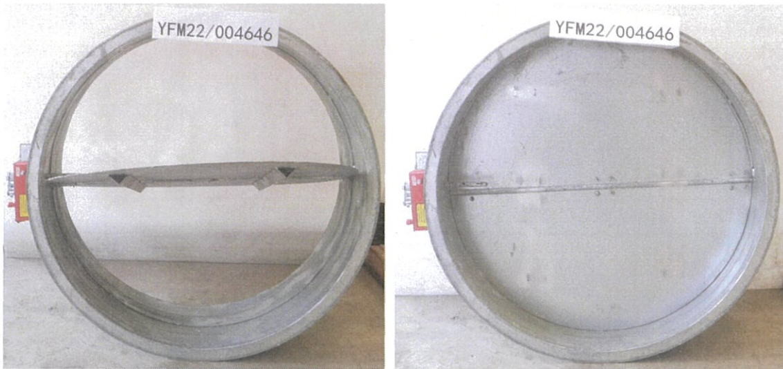
照片 1 耐火性能试验前试件情况
